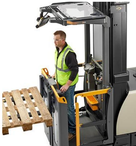
Otra posibilidad es que las horquillas vayan montadas sobre un carro de un segundo mástil elevador incorporado a la cabina, de forma que el operador puede ir elevando o descendiendo la carga a la altura que le sea más cómoda para efectuar su trabajo.
