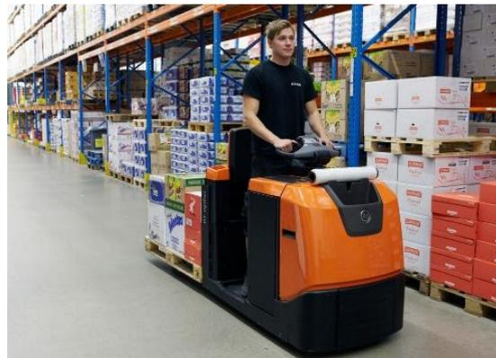
La máquina dispone de espacio para un conductor y tiene capacidad para transportar uno o dos palets. Las preparadoras de pedidos con horquilla extralarga pueden manejar de dos o tres palets a la vez.
