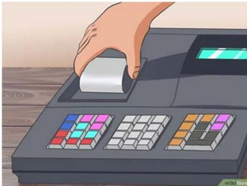
Después, se introduce el rollo de papel de forma que llegue hasta la parte delantera de la caja registradora, en donde se podrá rasgar los recibos para los clientes.
