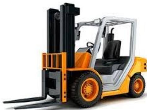
portantes en la cual la carga, transportada entre los dos ejes, puede ser situada en voladizo por avance del mástil, del tablero porta horquillas, de los brazos de horquilla o de carga lateral, se utiliza para apilado y almacenaje elevados.
