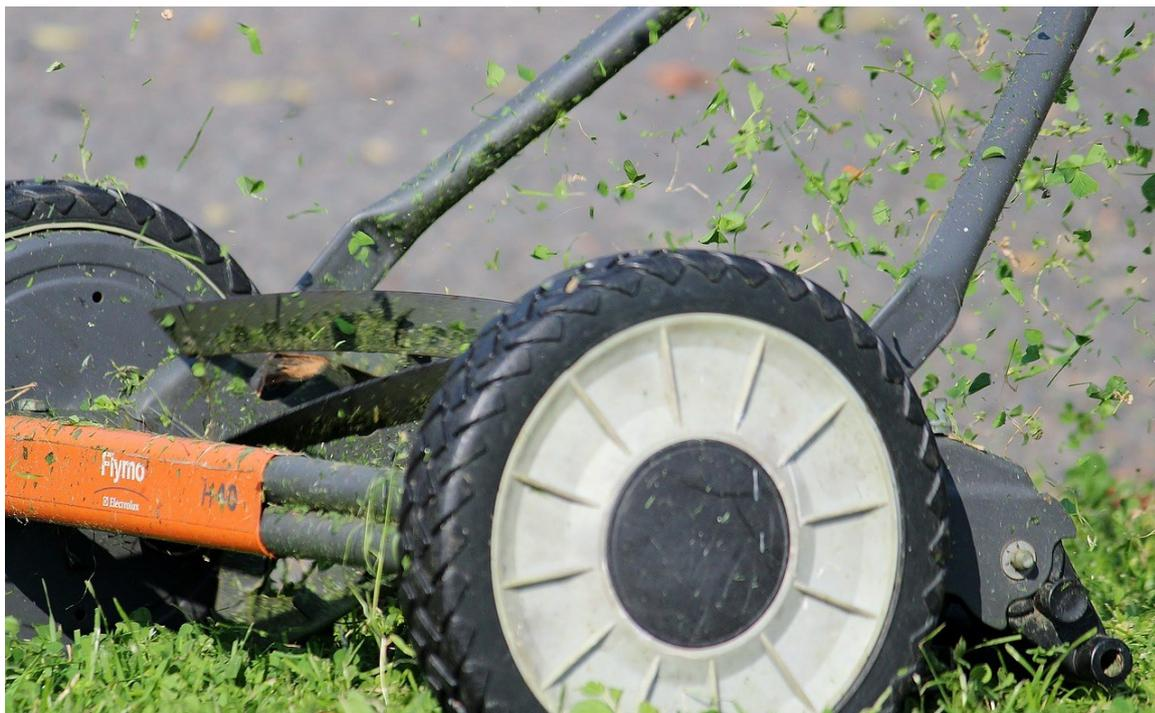
Segadora de cuchilla helicoidal, se aprecia la forma de dar el corte, el mejor para el césped, (Imagen Pixabay).
