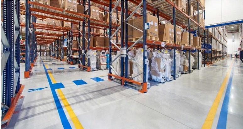
La señalización se efectúa con pinturas especiales a base de resinas, pues son más resistentes al desgaste y la abrasión. Con la ayuda de una máquina trazadora o con moldes, se dibujan líneas para delimitar áreas.
