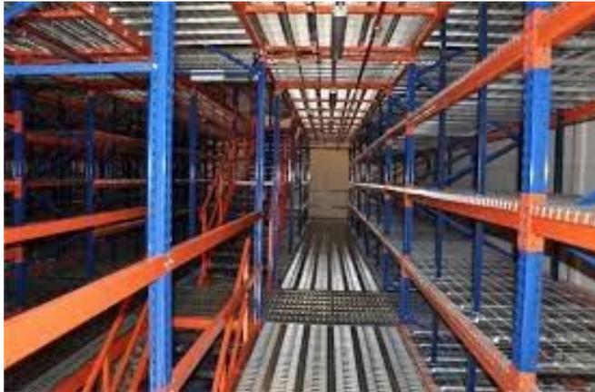
Aunque la NTP 852 especifica que los bastidores laterales se han de prolongar por encima del último nivel de carga en 0.5 m y en 0.1 m los interiores, es recomendable prolongar los bastidores laterales exteriores a la altura de la unidad de carga para proteger al personal de la caída de mercancía.
